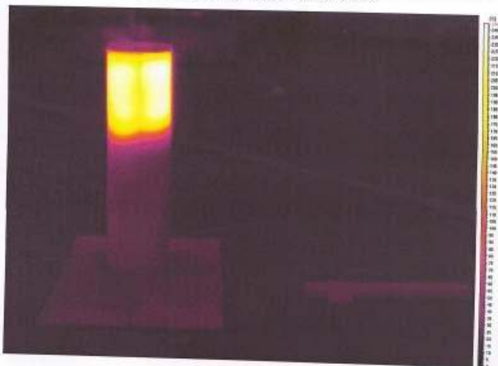
Fot. 12 Termogram koszopopielnicy w początkowym okresie badania
